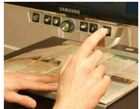
Erweitertes Bedienfeld mit 6 Funktionstasten und Drehregler.
